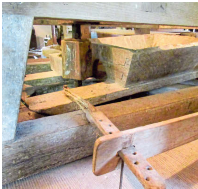
Der Rüttelschuh ist eine raffinierte Erfindung. In der Mühle regelt er, wie viel Korn zwischen die Steine fließt. Von einer Blattfeder (vorn) gezogen, prallt er immer wieder gegen den rotierenden „Vierknack“ (oben links). Das lässt die Mühle klappern. Foto: Christoph Mörstedt
