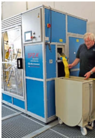
Die Kreisfeuerwehrzentrale hat eine neue Schlauchpflegeanlage.
