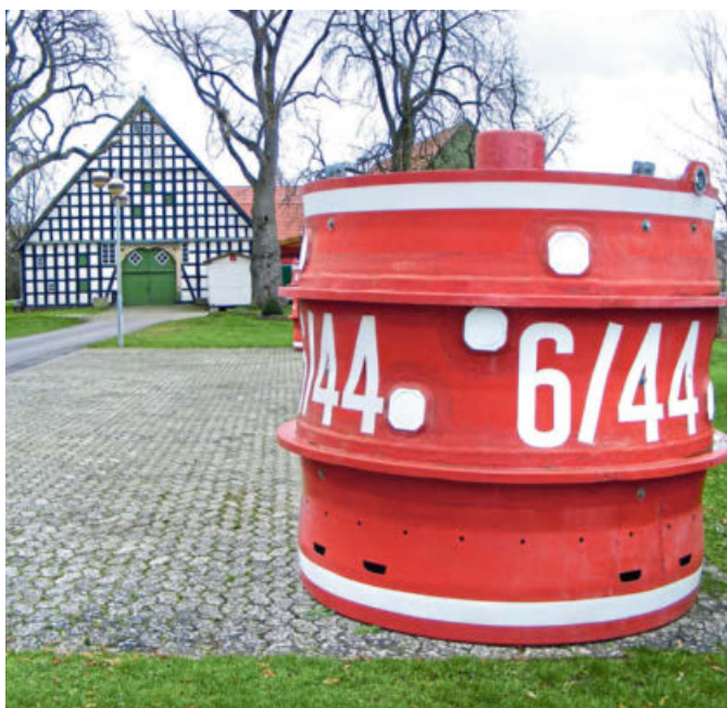
Die 4.000-Liter Löschwierzbehälter waren in Niedersachsen im Hubschrauber-Einsatz.
