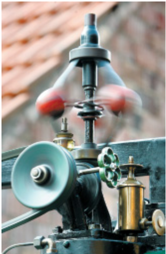
Geregelt: Der Fliehkraftregler steuert die Drehzahl.
