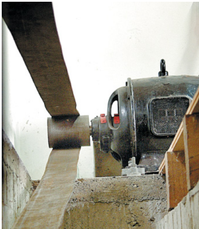
Wieder in Form: Nach 40 Jahren Stillstand dreht der AEG-Motor von 1919 den Schrotgang im Ziegelhäuschen. FOTO: FRENSING
