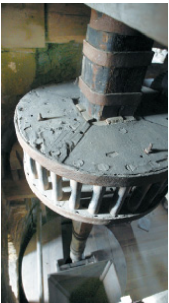
Korbrad: Mit der Kraft des Windes wird der Mühlstein gedreht.
