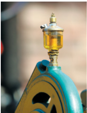
Geölt: Der Vorrat an Schmiermittel ist stets im Blick.
