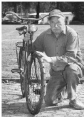
Auch eine Lösung: Gerhard Grenzebach zeigt ein Rad mit Vollgummimiklötzen als Notbereifung.
