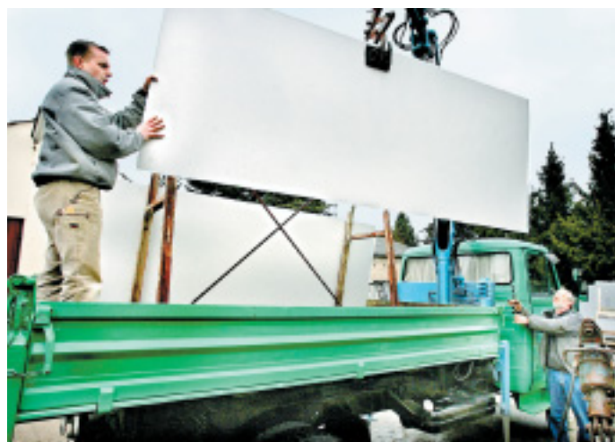
300 Kilo – kein Problem: Der Meiller-Kran stemmt eine Kunststeinplatte. Auf dem Bau macht er sich oft nützlich. FOTOS: KIEL-STEINKAMP
