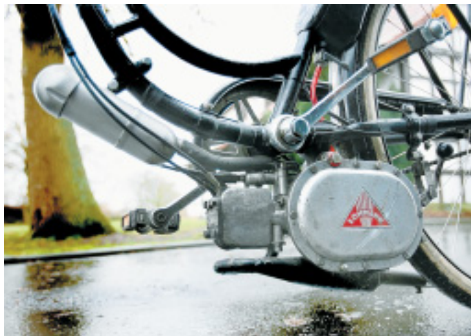
Energiespeicher: Im Tank befindet sich ein Petroleum-Öl-Gemisch, links davon der Ansaug-Schalldämpfer, der Luft in den Mischer bringt.
