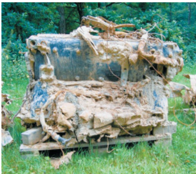
In Enger ausgebuddelt: Der Zwölfzylindermotor der Messerschmitt Bf 109 G 6 von Daimler-Benz. Er leistete 1.475 PS bei 36 (!) Litern Hubraum. Der Motor bohrte sich beim Aufschlag ca. 4,5 Meter in den Boden.
