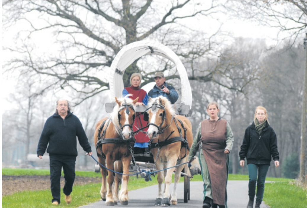
Fahrversuch: Max und Moritz ziehen den Nachbau des mittelalterlichen Frachtwagens, mit den Leinen ziehen die Helfer die Deichsel in die Kurve.
