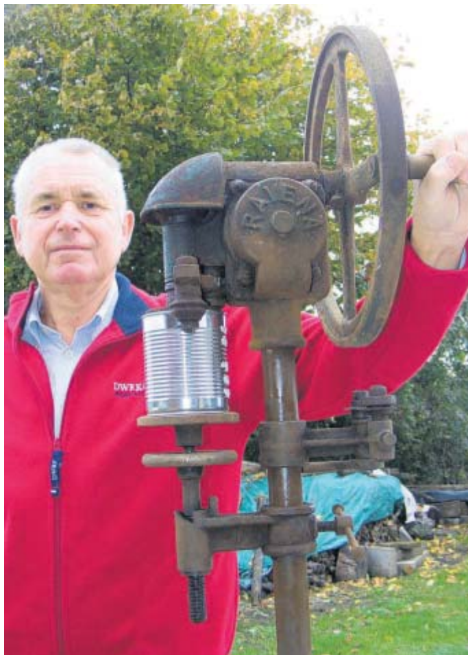
Dose zu: In zwei Schritten bördelt Werner Sidowskis Apparat Deckel und Dosenzarge zusammen. Der Dosenteller ist höhenverstellbar, weil die Dosen durch das Beschneiden von Jahr zu Jahr kleiner werden.
