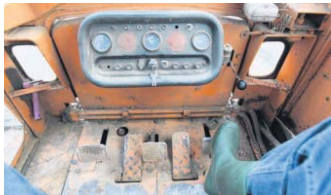
Arbeitsplatz: Fünf Pedale für das Steuern und Bremsen.
