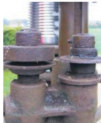
Scharf: Zwischen zwei Scheiben werden die Dosenränder glatt abgeschritten. FOTOS: KIEL-STEINKAMP
