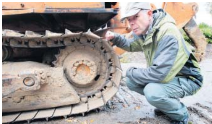
Kettenlaufwerk: HF-Tester Mörstedt an der Antriebsachse.
