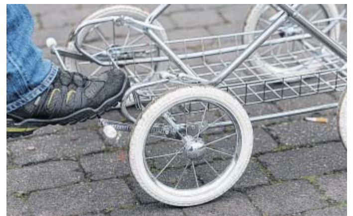
Mit Sicherheit: Die Feststellbremse verhindert das Wegrollen. Das verchromte Stahlrohrgestell kann als unverwundlich gelten.
