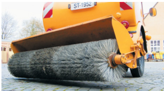
Bürstenwalze: Das Werkzeug ist schwingend und schräg zur Fahrtrichtung aufgehängt. Es legt den Kehricht nach rechts ab.
