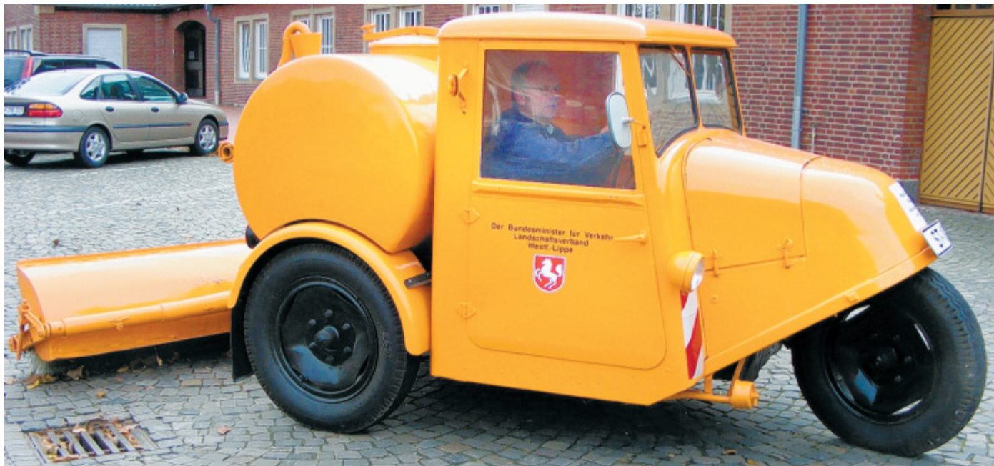
Kurz und wendig: Georg Friggemann steuert das dreirädrige Reinigungsgerät mit dem kleinen Treckermotor und der zierlichen Haube über den Hof. Über der Hinterachse sitzt der Tank, groß genug für 1000 Liter Wasser.
