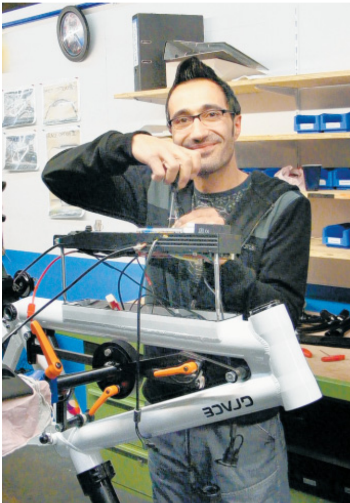
Montieren: Murat Gök baut hochmoderne „Grace“-E-Bikes, Stück für Stück. Statt automatischer Fertigung ist Handarbeit gefragt.
