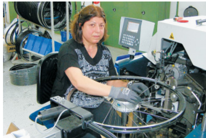
Einspeichen: Aus Nabe, Felge und Speichen setzt Güldane Güllinc Laufräder zusammen. Dabei hilft ein Schraubautomat.
