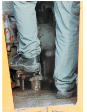
Stopp: Per Fußhebel wird die Walze zum Stillstand gebracht.
