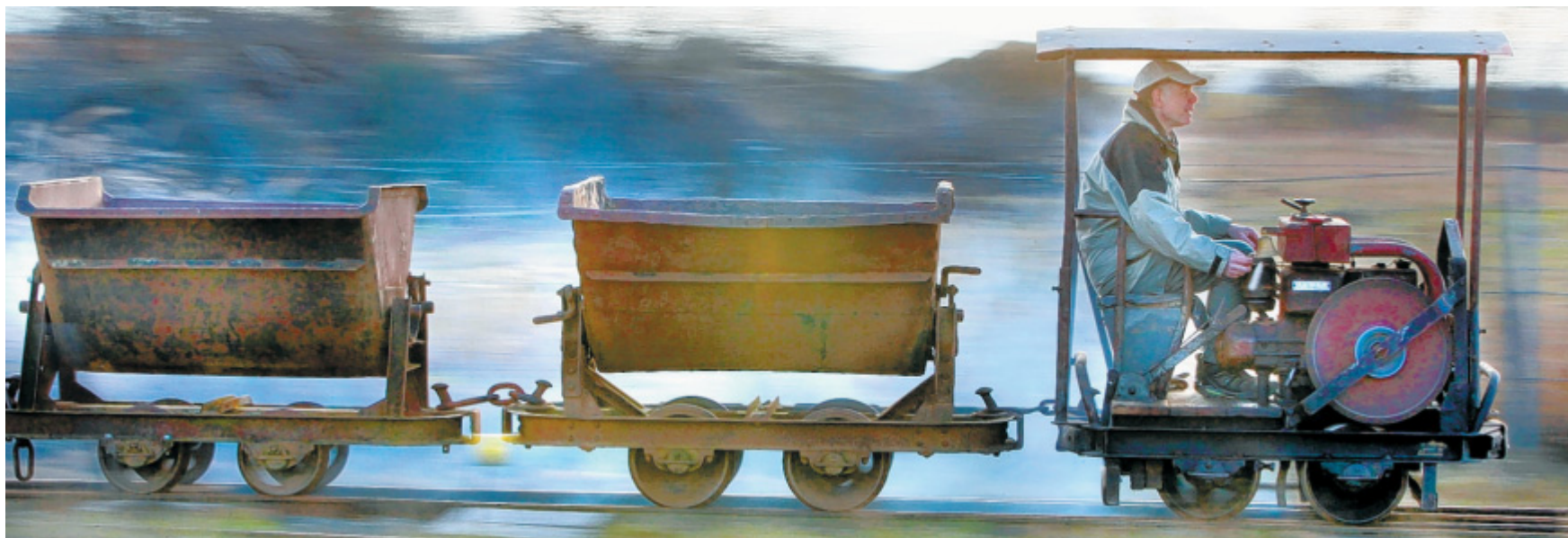
Mit dem Schienenkuli unterwegs: 6 PS bringt die Lok auf die Feldbahn-Schiene und lässt eine blaue Abgasfahne hinter sich.
