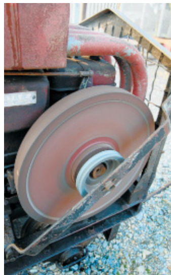
Stationärmotor: Der Diesel läuft mit konstanter Drehzahl. Am Schwungrad wird er angedreht.
